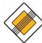
Konec hlavní pozemní komunikace - P 3
